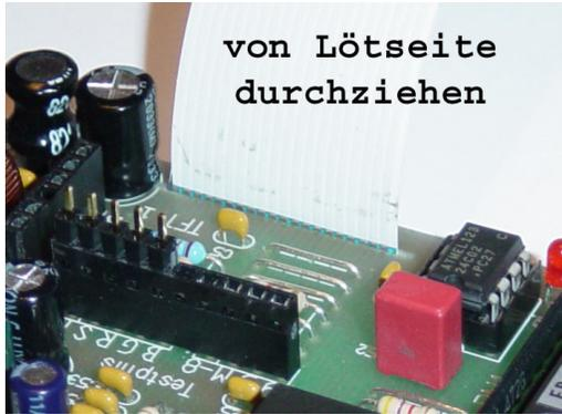
Abbildung 7: Einsetzen der Leitung in die Platine
