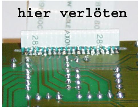
Abbildung 8: Einlöten der Flexleitung
