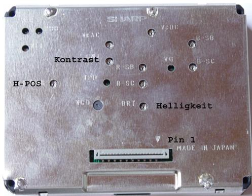
Abbildung 9: Lage der Abgleichpunkte am TFT
